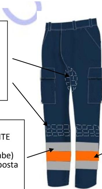
N 2 BANDE RETRORIFLETTENTI (che circondano completamente le gambe) di colore grigio chiaro rifrangente tipo microsfera, di altezza pari a 5 cm di cui una posta in corrispondenza del polpaccio l'altra posta ad almeno 5 cm sopra il bordo inferiore.
